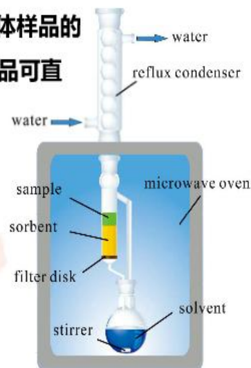
微波辅助选择性索式抽提技术示意图
